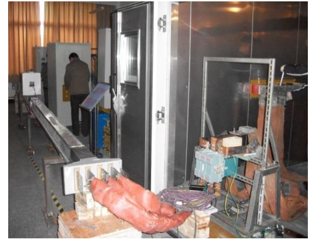
Clause 8.2.1.8 : Thermal Cycling Test
